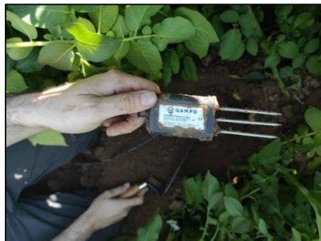
**Imagen 11.** Sensor de humedad tipo FDT sensitivo instalado en el proyecto (Qampo).
